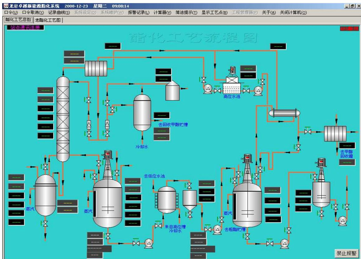
7、两台生产控制工业计算机互为热备份的冗余系统，一台故障后，另一台自动切换为主机，生产系统和管理系统仍可获得数据。
