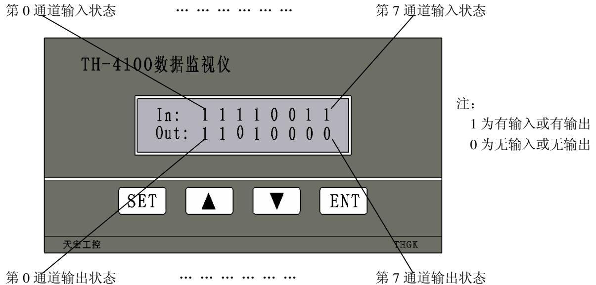
通过智能接口可以外接 TH-4100 数据监视仪。数据监视仪可以用来参数设置, 还可以作为模块的人机界面使用。数据监视仪采用液晶显示, 可以同时显示十六个通道开关量状态。
